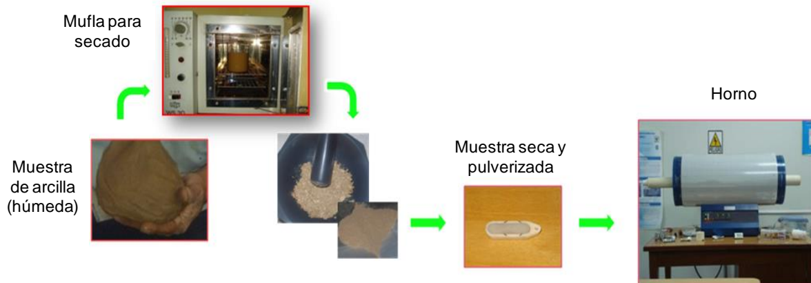
Figura 3. Secado, pulverizado y preparación de las muestras de arcilla para el tratamiento térmico en el horno.
