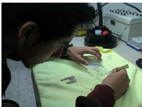
Figura 12. Manejo propio de las puntas cantiléver de la celda de fluidos del AFM.
