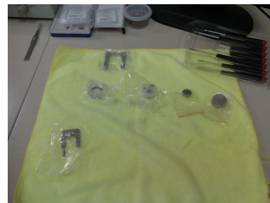
Figura 3. Partes elementales que componen la celda de fluidos del Microscopio de Fuerza Atómica del Laboratorio de Nanotrónica.
