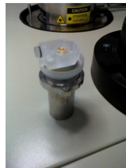
Figura 9. Colocación del recipiente alojador de las muestras a estudiar de la celda de fluidos.
