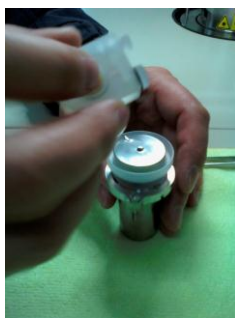
Figura 8. Colocación y ubicación de la charola de metal sobre el sensor piezoeléctrico.
