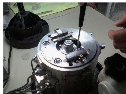
Figura 5. Desmontaje del sensor piezoeléctrico del AFM.
