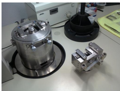
Figura 4. Desmontaje del cabezal del AFM.
