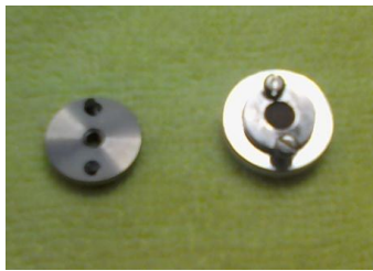
Figura 6. Comparación del sujetador que se coloca en la parte superior del sensor piezoeléctrico. Izquierda: disco para celda de fluidos. Derecha: disco para estudio de muestras solidas.
