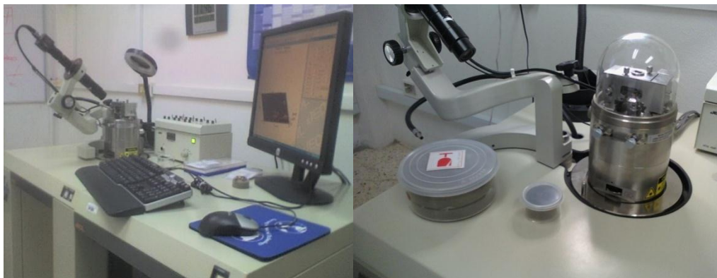
Figura 1 Microscopio de Fuerza Atómica utilizado en el Laboratorio de Nanotrónica de la Facultad de Ciencias de la Electrónica-BUAP.
